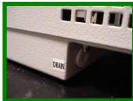
Drain은 장비 왼쪽에 있고 plate에 넘친 용액을 빼내기 위함입니다. Drain은 안전한 장치이고 만약 사용자가 장비를 매뉴얼에 설명된 절차대로 세척하지 않는 경우 유용하게 사용할 수 있습니다.
